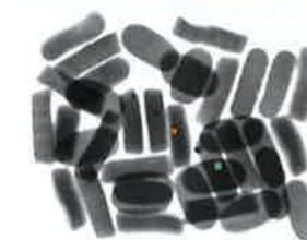
Obrázek 6 Keramické kalibrované kontaminanty, v želé bonbónech. Používají se například pro potvrzení správnosti nastavení rentgenu.
